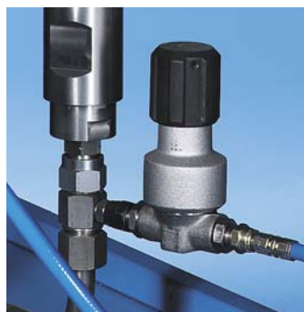
Zpětný ventil zajišťuje konstantní teplotu stříkaného materiálu při použití verze Hot Spray s cirkulačním systémem.
